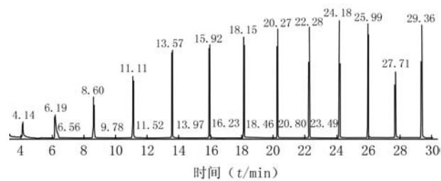
图 2 正构烷烃 C<sub>8</sub>~C<sub>20</sub> 的 GC-MS 总离子流图
